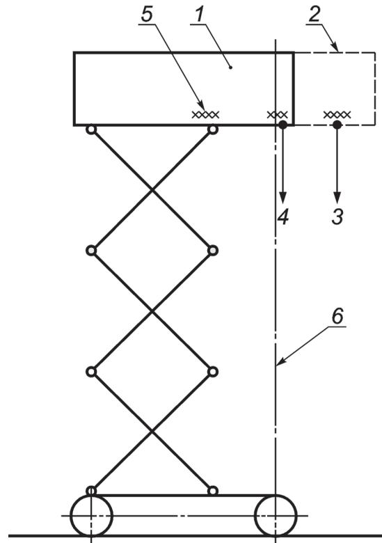
1 — основная рабочая платформа; 2 — удлиненная часть платформы (полностью выдвинутая); 3 — номинальная нагрузка (удлиненная часть платформы),  $m_{ext}$ ; 4 — номинальная нагрузка (основная платформа),  $m_{work}$ ; 5 — снятие стабилизирующей части нагрузки на основной рабочей платформе; 6 — линия опрокидывания
