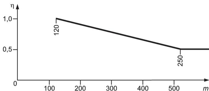
$m$  — масса, кг;  $\eta$  — спектральный коэффициент нагрузки.
