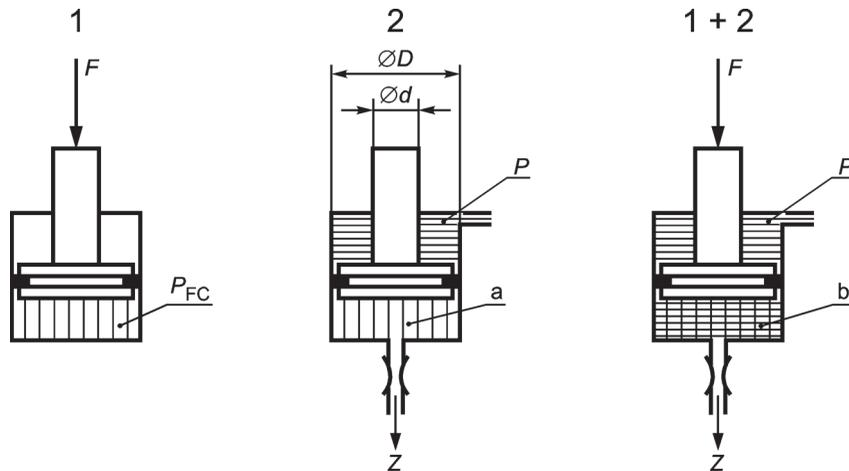
$D$  — диаметр поршня;  $d$  — диаметр штока поршня с цилиндром на растяжение, а блок регулирования скорости действует на кольцевой зазор;  $F$  — нагрузка;  $P$  — давление в системе;  $p_{FC}$  — нормальное давление;  $Z$  — ограниченный расход;
